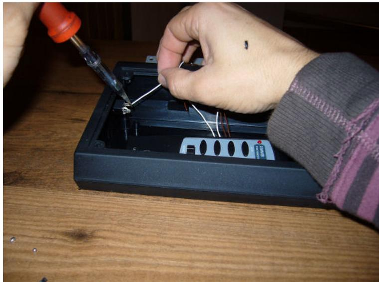
Fotografía de soldadura de cables a la clavija hembra.
