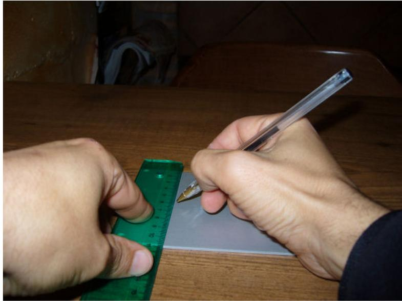
Fotografía del dibujo de los agujeros que llevará la tapa de la caja de conexiones.
