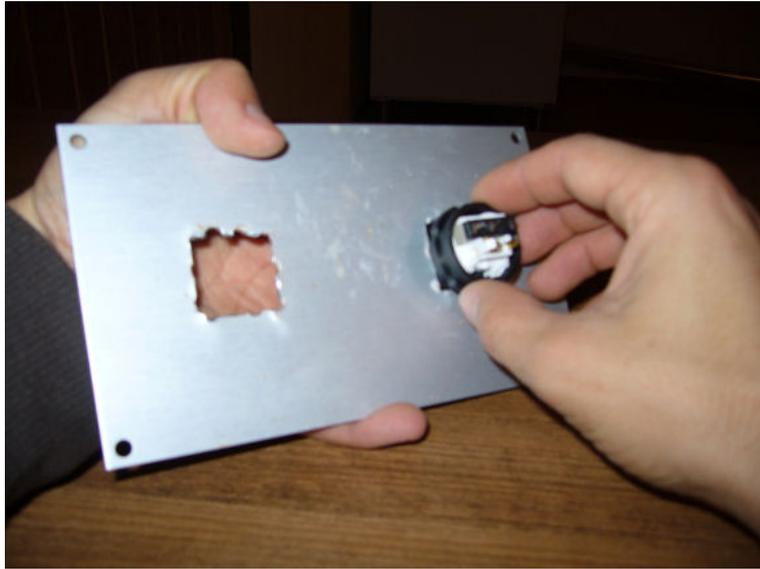
Fotografía de la colocación de los pulsadores en la tapa de la caja de conexiones.
