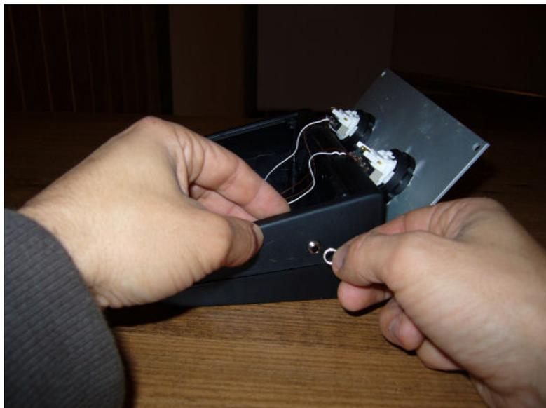
Fotografía del apriete con tuerca de la clavija hembra.
