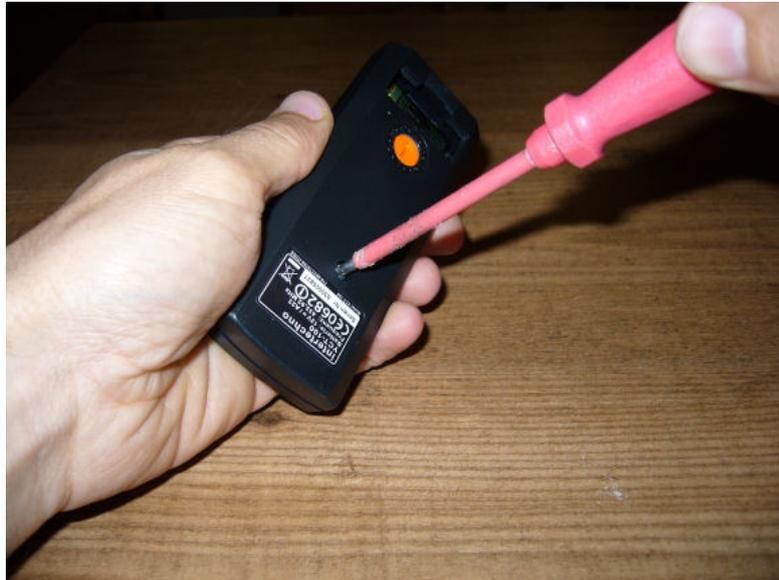
Fotografía de desmontaje de mando a distancia.
